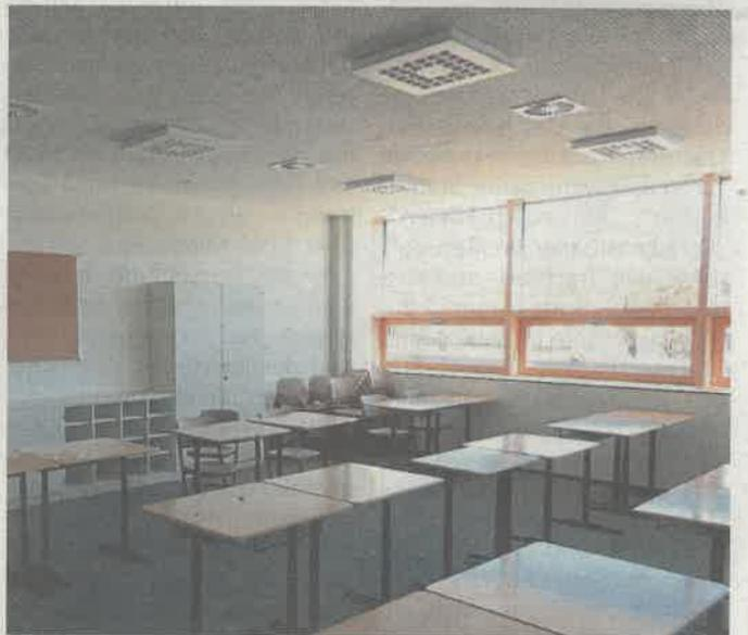
**Die Klassenräume sind ebenfalls auf neuestem Stand. Ein Öffnen der unteren Fensterteile ist zwar möglich, aber durch die zentrale Lüftungsanlage nicht erforderlich.**
